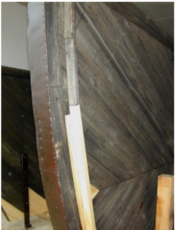
Detail: Geschlossene Flächen mit Stabilisierung und Ergänzungen von Neuteilen
