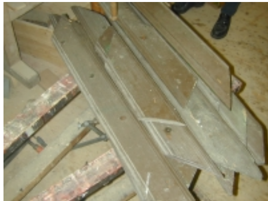
Detail: Holzschäden, abgefaulte Holzteile und Längsrisse
