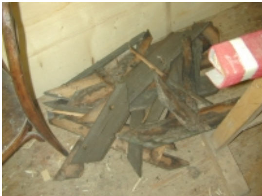
Detail: Holzschäden, abgefaulte Holzteile und Längsrisse
