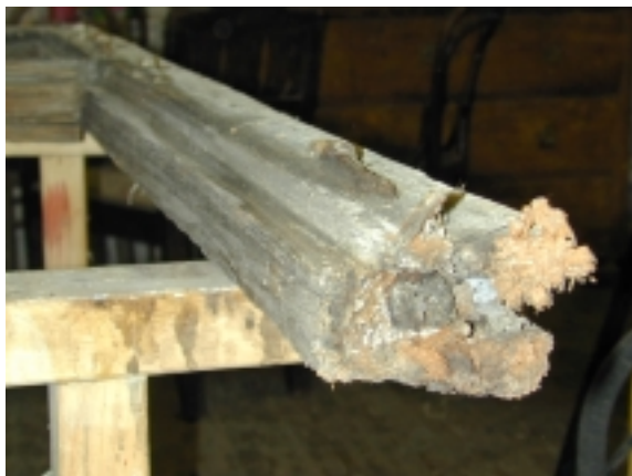
Detail: Abgefaulte Holzteile,
